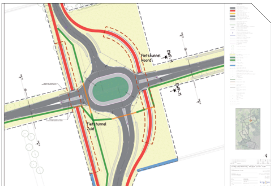
Ongelijkvloerse kruising van ovonde met twee fietstunnels bij de Diepveldeweg in Bergeijk, een NLCS-project van Kragten.
